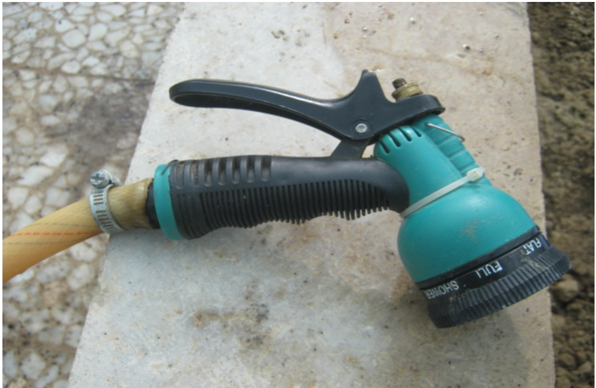
شکل ۱۰- نمونه ای از نازل تنظیم کننده آب که برای آبیاری خزانه‌های با وسعت کم مورد استفاده قرار می‌گیرد
