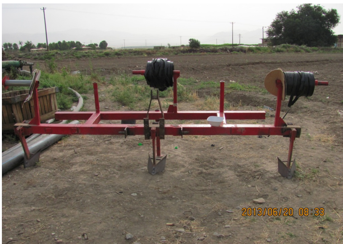
شکل ۱۵- دستگاه تیپ‌کشی جهت استقرار سیستم آبیاری قطره‌ای در مزرعه
